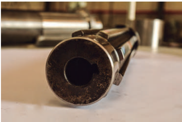
Eje primario de convertidor en Acero 4140 templado y rectificación.
