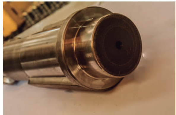
Eje secundario de convertidor en Acero 4140.
