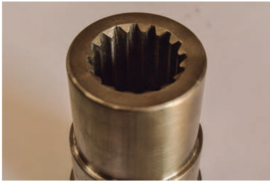
Acople de convertidor en Acero 1045.
